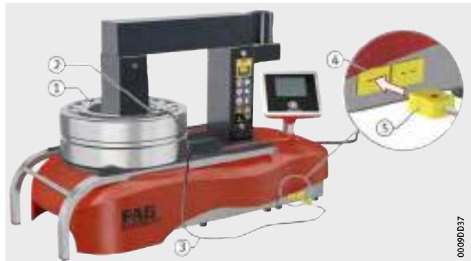
Рисунок 40 Подключение и установка датчика температуры
