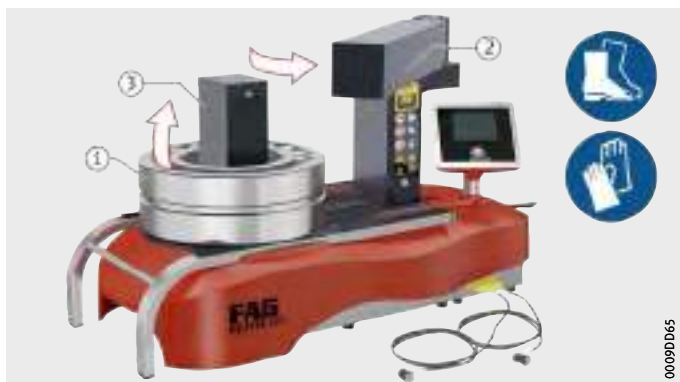
Рисунок 49 Снятие горизонтально уложенного подшипника качения
